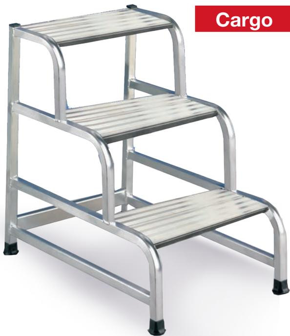
Sgabello professionale a gradini ad un tronco di salita. In alluminio interamente saldato, forma un monolito ultra-resistente ideale per utilizzo su macchinari in officina e per l'accesso a piani di carico. Gli ampi gradini piani antiscivolo in estruso nervato sono saldati ad una robusta struttura tubolare (mm 25x25). La base è svasata con un appoggio a terra estremamente ampio (cm 50) che gli conferisce grande stabilità e comfort di utilizzo. È inattaccabile dalla ruggine.
