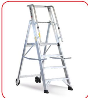
Scala doppia a gradini ad un tronco di salita provvista di ampia piattaforma, guarda-corpo e corrimano di salita. Ideale per utilizzo professionale. In alluminio estruso nervato é costruita saldando i gradini ai montanti, ottenendo un monolito ultraresistente. Può essere aperta e chiusa in pochi secondi.
